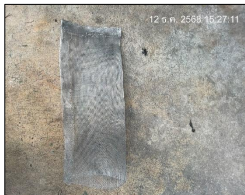
ภาพถ่ายที่ 2.2-17 อุปกรณ์ดักจับลูกไฟติดกับท่อไอเสียรถยนต์
